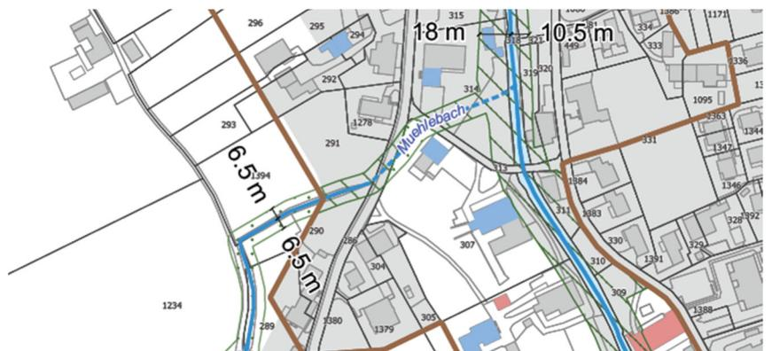
Abbildung 44: Eingedolter Gewässerabschnitt entlang des Mühlebachs
