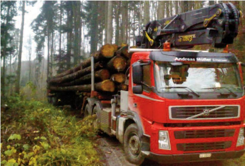
Gesamtgewicht beträgt 40 Tonnen. Das ergibt eine Nutzlast von etwa 22 Tonnen. Moderne Motoren, die auch die neuesten Umweltvorschriften problemlos einhalten, leisten bis 540 PS. Um den Fahrkomfort zu erhöhen und die Strassen zu schonen sind die Fahrzeuge mit Luftfederung ausgerüstet.
